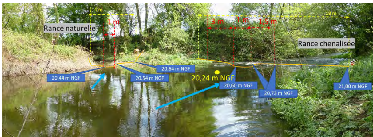
Figure 6 : Schéma de principe d'aménagement de la diffluence
