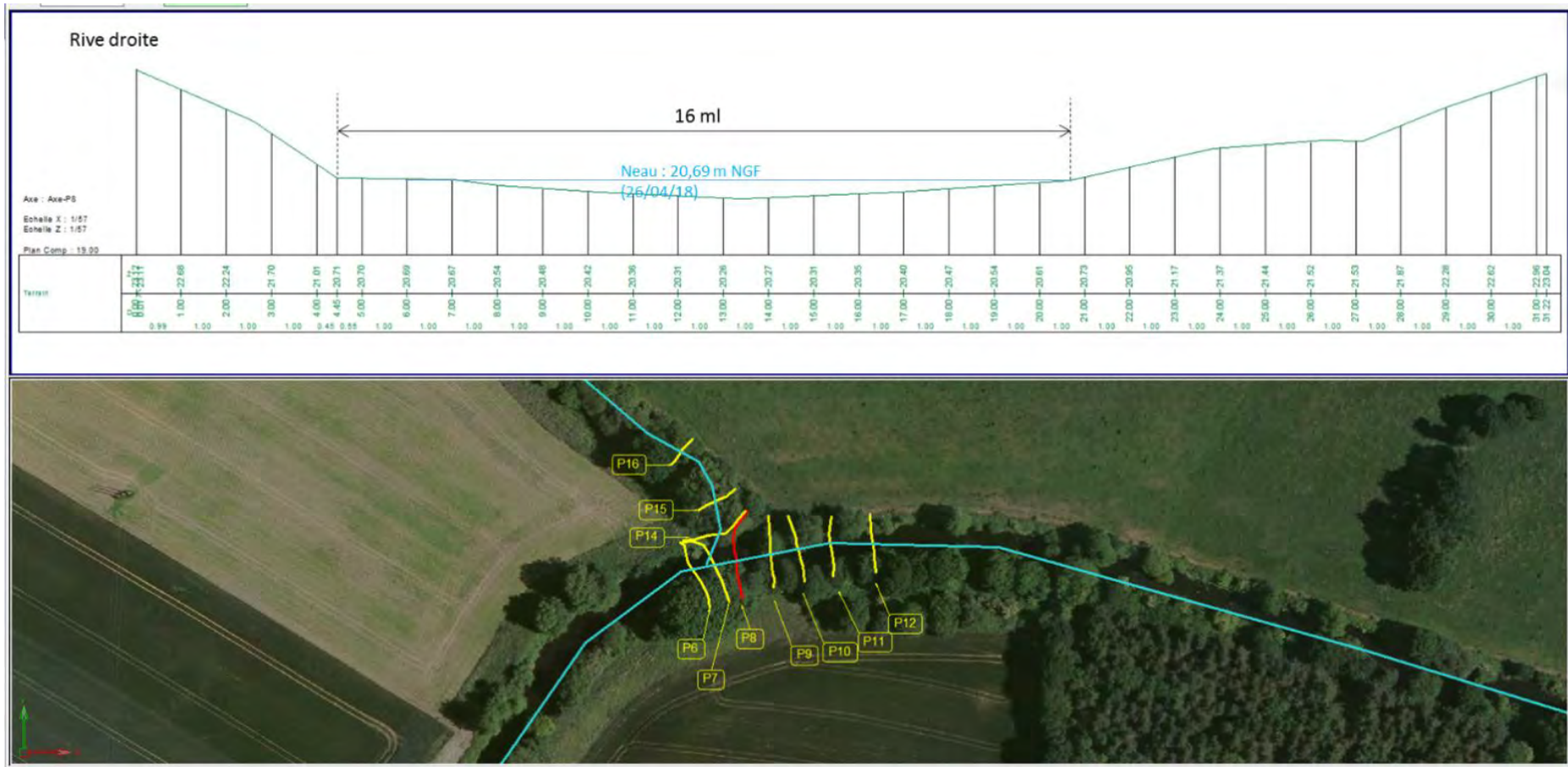
Figure 20 : profil amont radier(P8) Rance chenalisée
